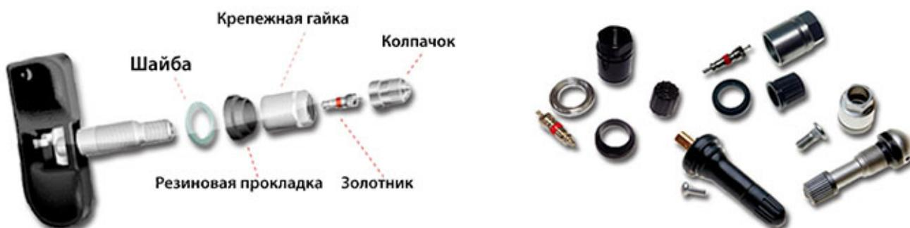
В свою очередь ремонтный комплект вентиля стоит недорого в отличие от вентиля в сборе, а его регулярная замена исключает преждевременный выход сенсора из строя. Также после замены элементов вентиля необходимо повторно проверить систему и в случае необходимости провести сброс настроек, используя специальный сканер-программатор TPMS.
