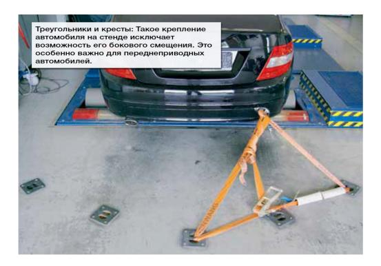
Удерживающие стропы должны иметь достаточное натяжение, но при этом не тянуть автомобиль вниз. Ремней с открытыми крючками следует избегать, поскольку они могут ослабнуть при проведении измерений. Не оставляйте свободными концы ремней, поток охлаждающего воздуха может затянуть их под колеса или в ролики стенда.
