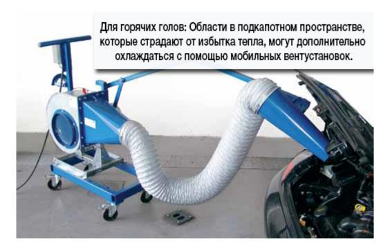
Опыт показывает, что при полностью открытой дроссельной заслонке может быть достигнута мощность более чем 25000 м³/ч и скорость 90 км/ч охлаждающего потока воздуха. Также необходимо учесть, что из-за теплового излучения от выхлопной системы автомобиля, необходимо обеспечить достаточный поток охлаждающего воздуха под его днище. 8.jpg
