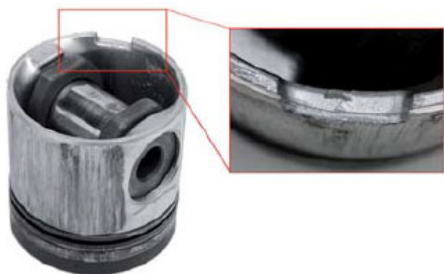
Фото 3: Видимые следы попадания охлаждающего сопла на поршневой шток
