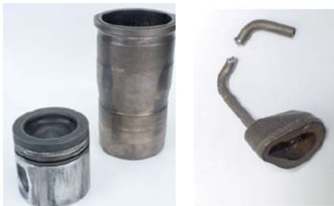
Фото 2: Установленное (сверху) и сломанное (нижнее) охлаждающее сопло
