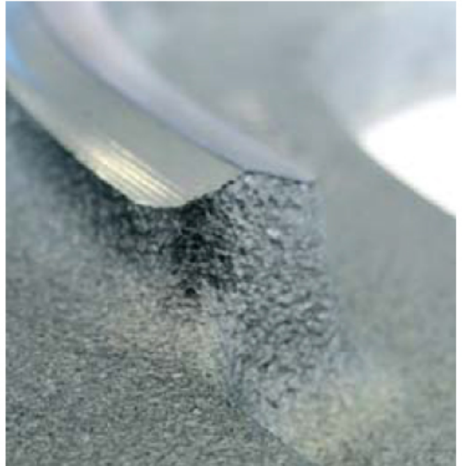
Новая и изношенная контактная линия нажимной площадки
