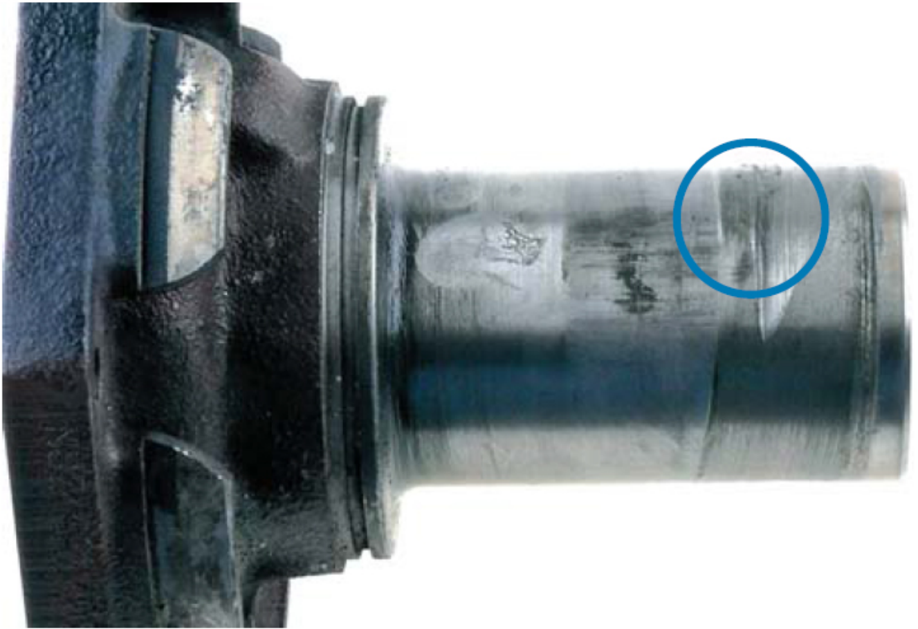
Износ направляющей втулки
