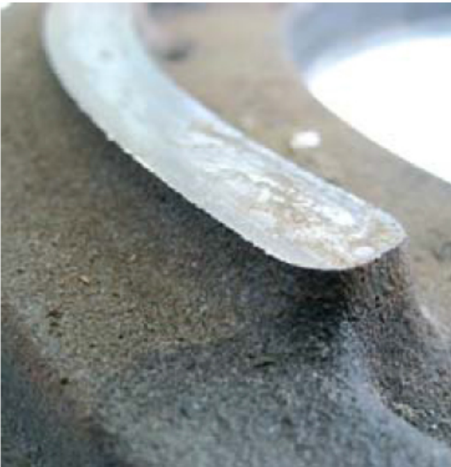
Новая и изношенная контактная линия нажимной площадки
