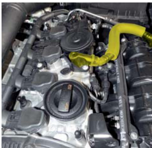
Рисунок 3: Вентиляционный контур перед турбонагнетателем
