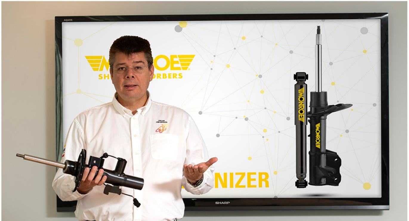
Поскольку внутренние компоненты нового амортизатора не были подвержены износу, использование нового амортизатора совместно с изношенным амортизатором может привести к неравномерному демпфированию. Это приведет к тому, что новый амортизатор будет изнашиваться на порядок быстрее, чем ожидалось, поскольку на него будет распределяться дополнительная нагрузка, компенсирующая износ старого амортизатора. В некоторых странах эта разница может быть причиной для отказа в прохождении технического осмотра.
