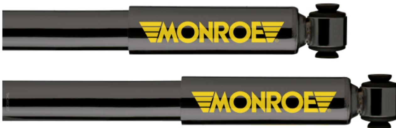
Как и другие компоненты автомобиля, амортизаторы, совершающие в среднем 2 800 рабочих циклов на километр пробега, подвержены износу. При замене изношенного или вышедшего из строя амортизатора крайне важно, чтобы на другой стороне автомобиля также был установлен новый амортизатор — это обеспечит их стабильные характеристики и предотвратит преждевременный износ.
