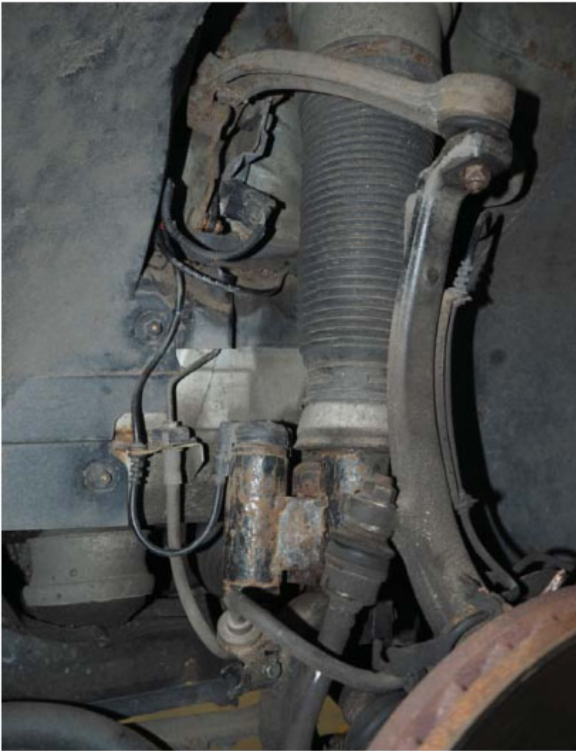
Фото 3: Старий пневмомодуль, втрачено герметичність системи. (Ймовірно ресурс вже вичерпано остаточно, або ж він на грані). Варто перевірити підвіску, замінити всі зношені деталі
