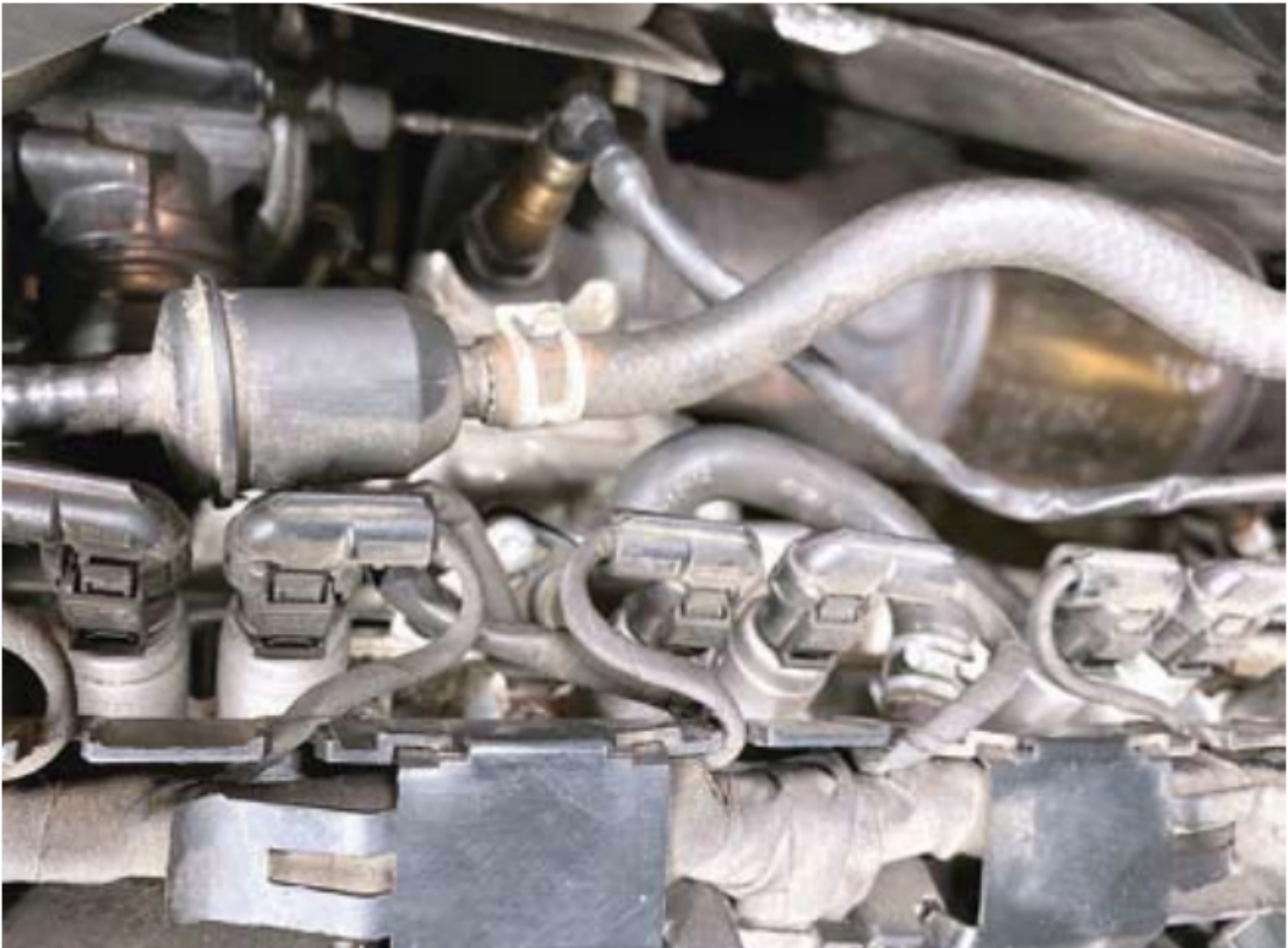
Фото 4. Електромагнітні стартери системи Audi Valvelift
