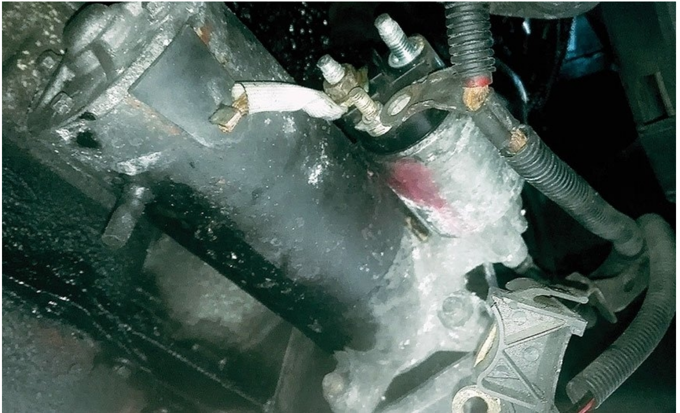
Фото.1. Відсутність необхідного контакту кабелю живлення стартера призводила до зниження його частоти обертання.
