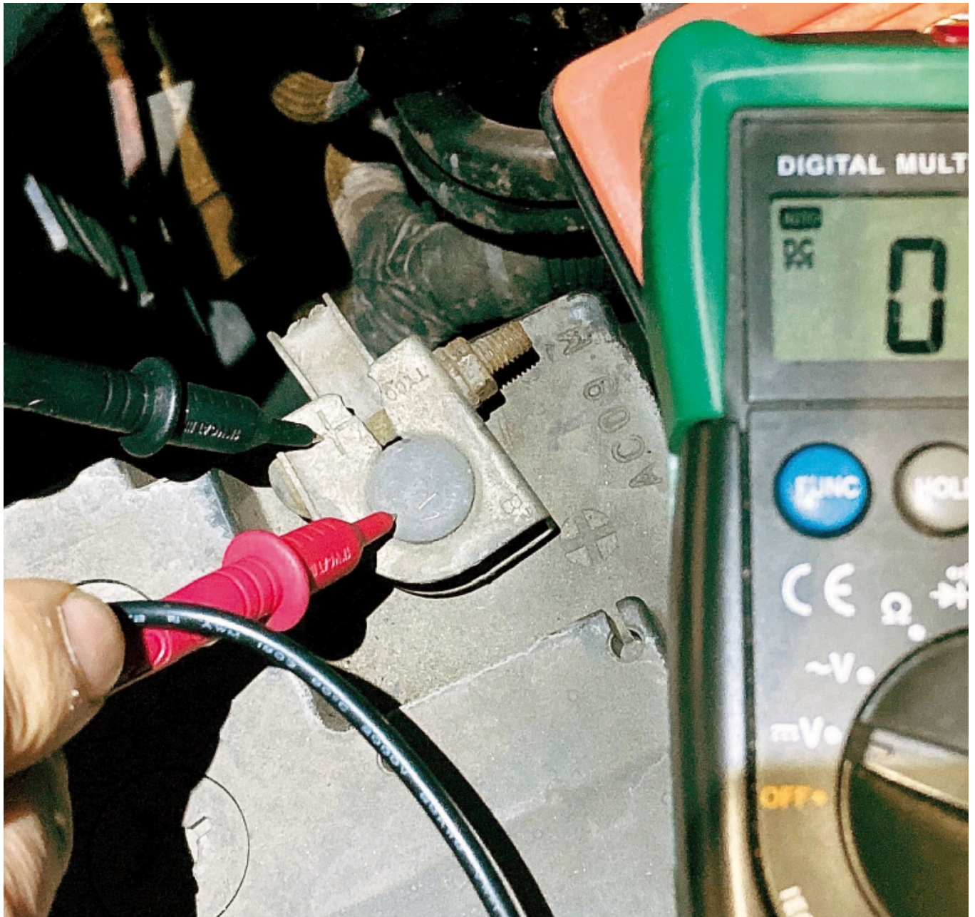
Фото.5. Діагностика проблем, пов'язаних з електричною системою автомобіля, повинна починатися з перевірки падіння напруги між полюсом і клемою АКБ.
