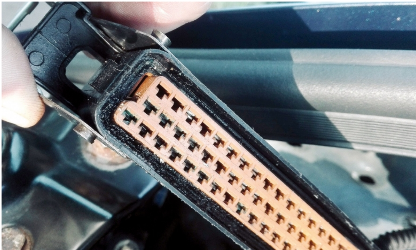
Фото.2. Приклад корозії та окислення контактів в клемному роз'ємі блоку керування двигуном.
