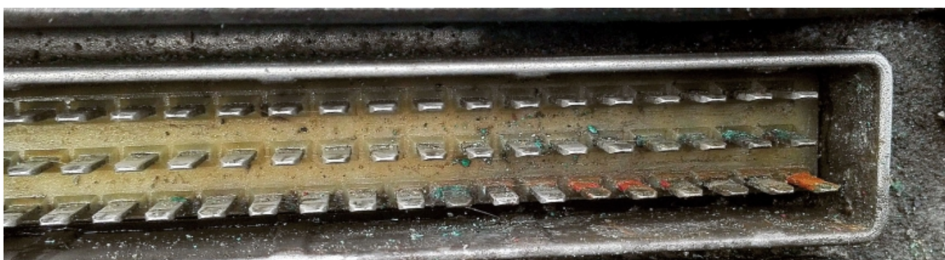
Фото.3. Окислені штифти клеми контролера АКПП викликали проблеми з перемиканням окремих передач.
