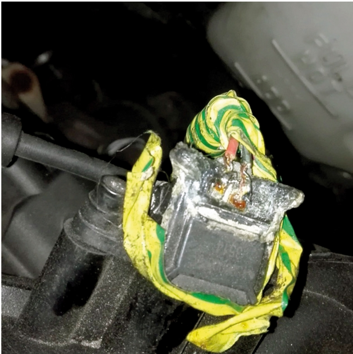
Фото.6. Причиною виходу з ладу датчика МАР стало неправильне підключення (пайка) його контактів.
