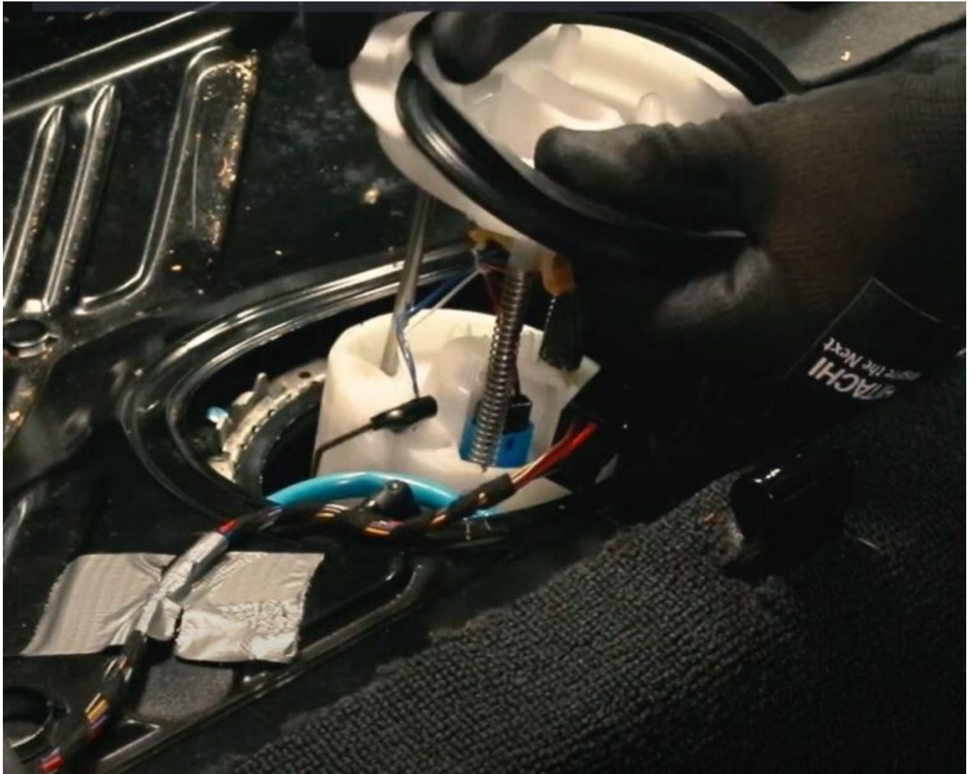
3.2. Правильно під'єднайте шланги подачі палива. (фото 8)
