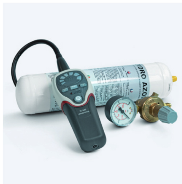
Фото.2. Електронний детектор («sniffer») для виявлення витоків
