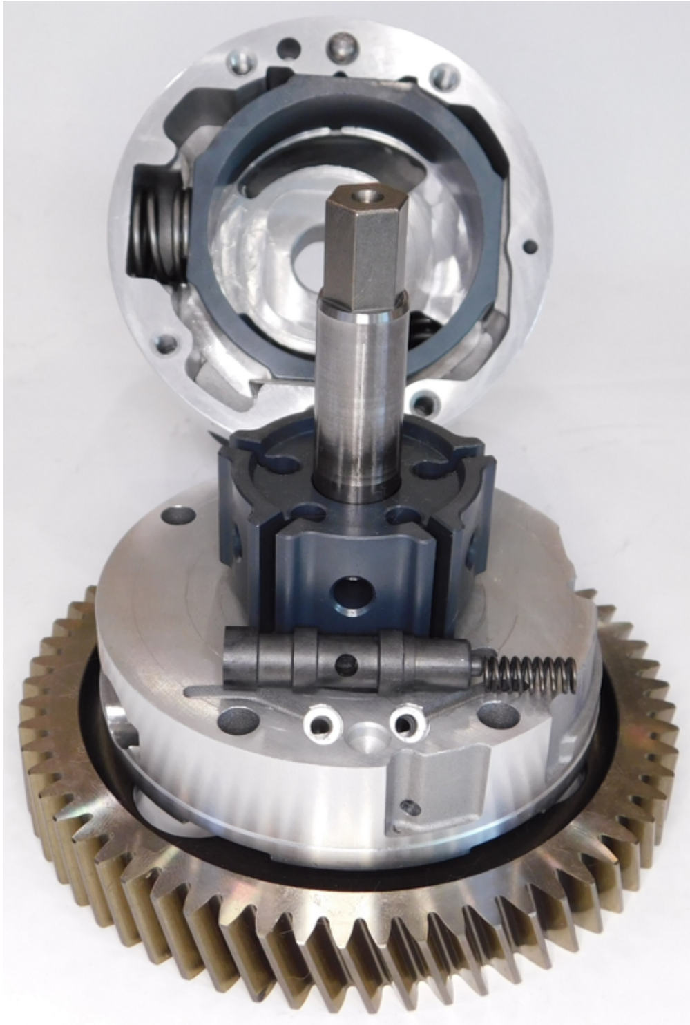
Мал. 2 Підпружинений керуючий плунжер
