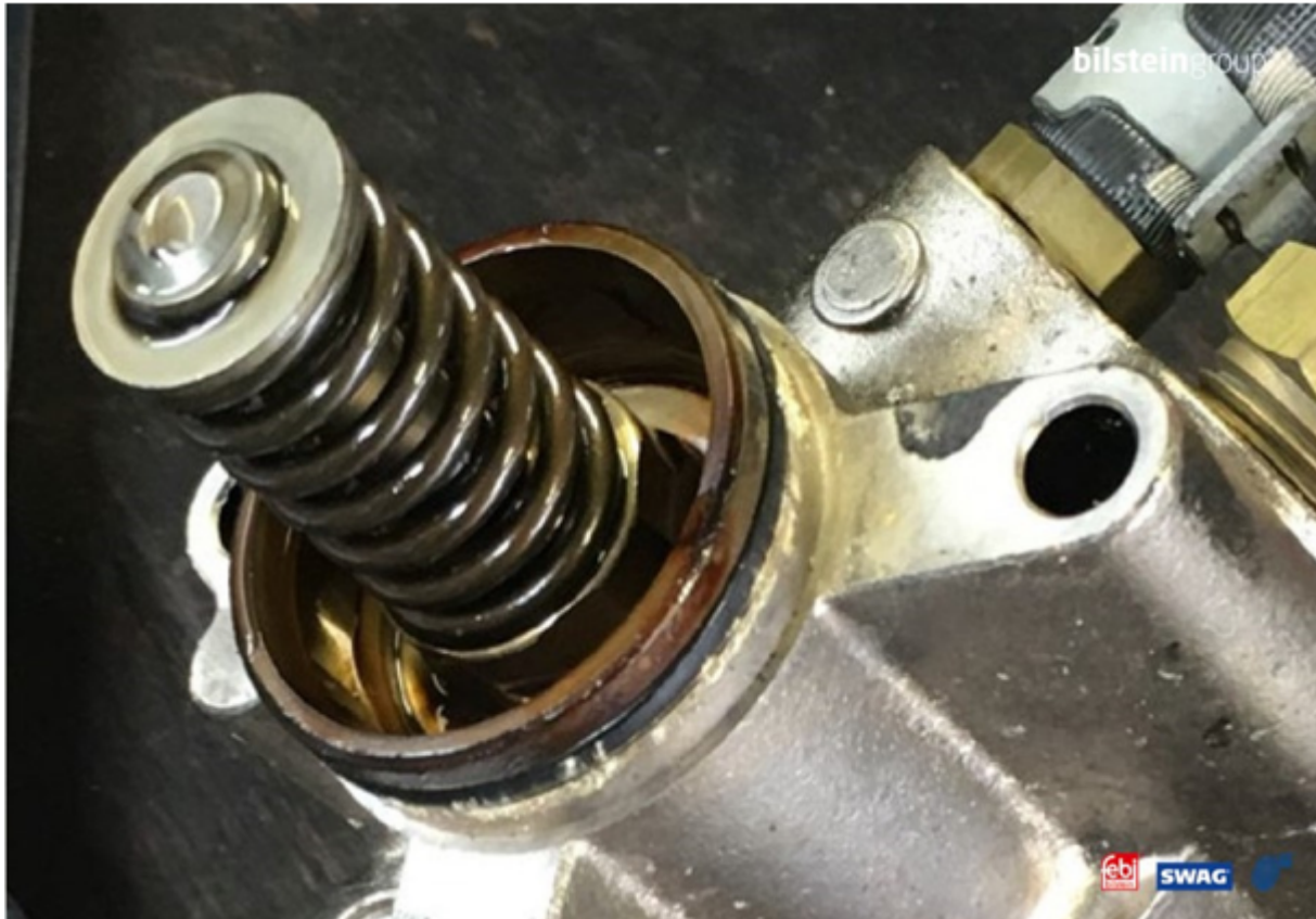
Мал. 2 Поршень паливного насоса високого тиску (показаний при знятому паливному насосі з двигуна)
