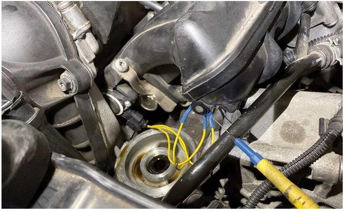
*Фото 1. Щоб зняти датчик положення заслінок G336 і отримати доступ до його штекера у двигуні 1.8 TFSI потрібно відкрутити оливний фільтр*
