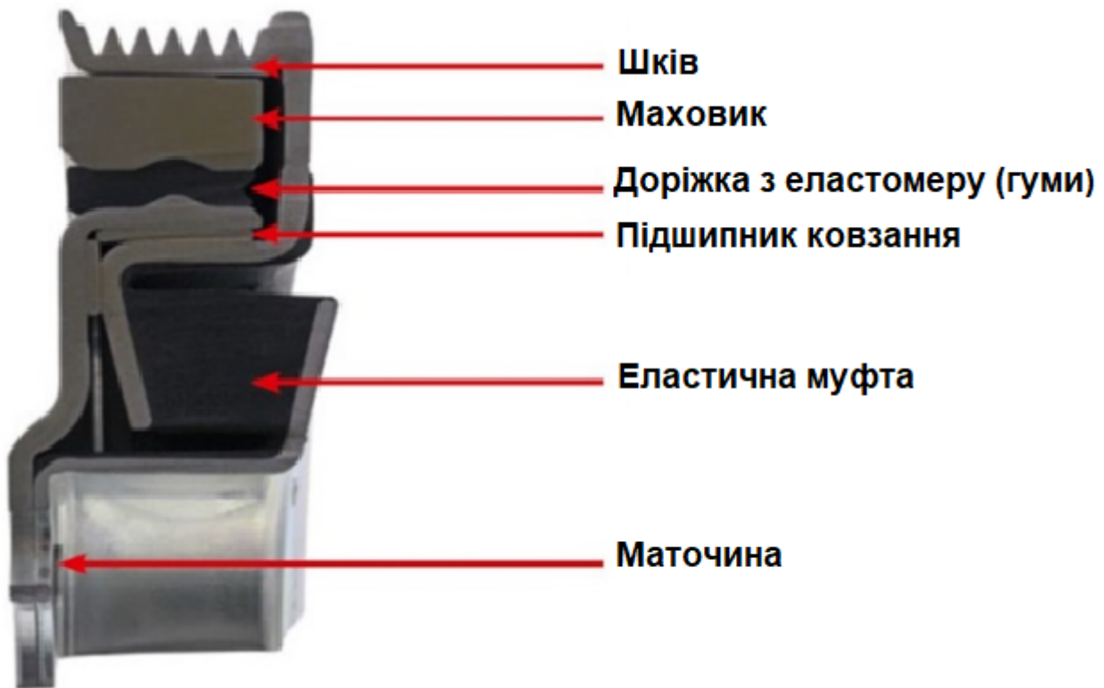
Мал.1 Багатошарова конструкція крутильних демпферів коливань шківів колінчастого валу
