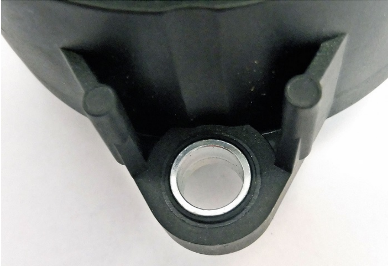
Фото 2. Отвір для кріплення вижимного підшипника
