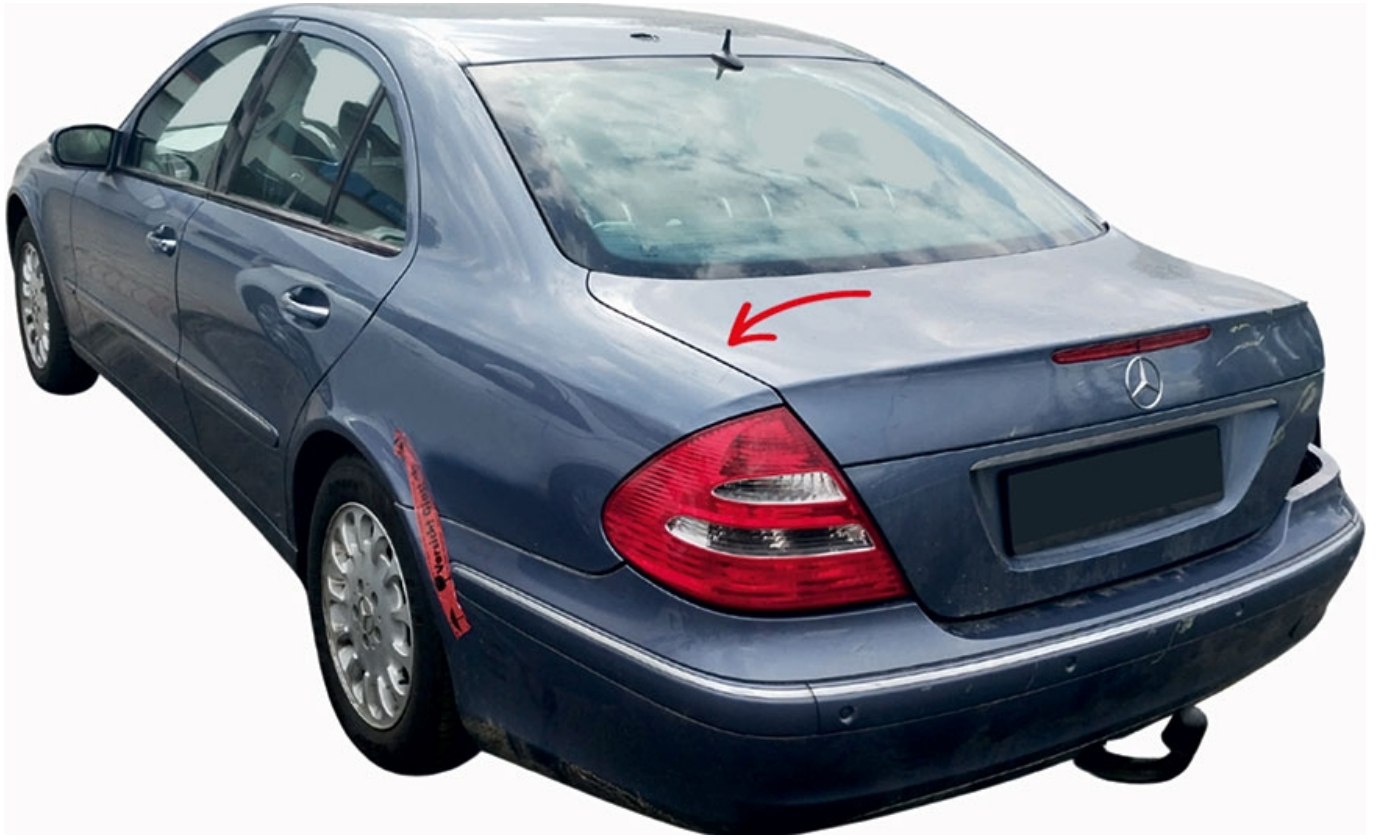
Фото. 4. Поверхня задньої кришки багажника та заднього крила (довга контактна лінія)
