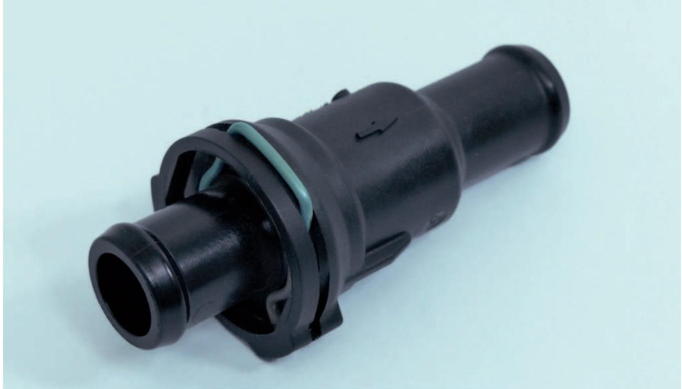
Фото. 2. Завжди звертайте увагу на напрямок монтажу (позначений стрілкою) під час встановлення термостата.
