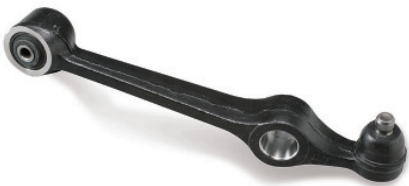
Фото 1. Важіль підвіски з інтегрованою кульовою опорою.
