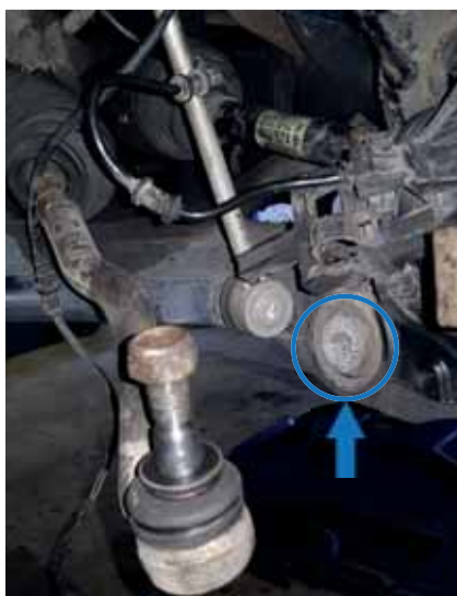
Фото 8. Знос/пошкодження втулок кріплення амортизаторів у важелях підвіски
