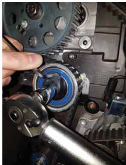
Натяжитель, закрепленный гайкой (закрученной с усилием пальцев)
