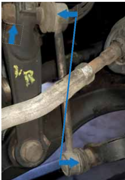
Фото 3. Люфти і дефекти стабілізатора, з'єднувальних тяг та втулок
