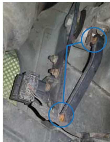
Фото 9. Знос/пошкодження шарнірів тяги датчика висоти/рівня
